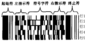
图2 PDF417条码的结构
